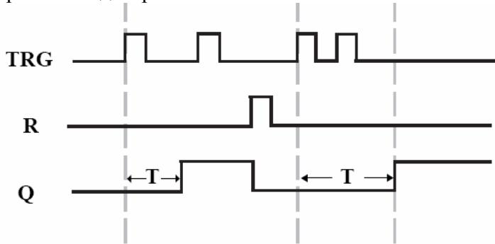
Если происходит изменение состояния триггера TRG из "0" в "1", то включается таймер. По истечении времени T, выход Q переключается в "1". Следующий сигнал на входе TRG триггера не влияет на состояние выхода Q. Только когда на входе триггера R появится сигнал "1", выход Q восстановит состояние "0".
