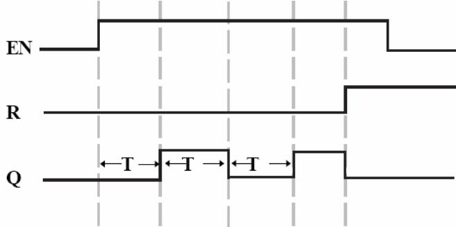
Используйте параметр Т для установления времени включения/выключения. Допустимый диапазон значений Т от 0,01 до 99,99. За единицу могут быть приняты часы (Н), минуты (М), секунды (С). Точность уставки составляет 0,05 с. Вход EN запускает генератор. Выход Q будет переключаться всякий раз по истечению времени Т. Так будет продолжаться до тех пор, пока на выходе EN присутствует «1». Данная функция применима для задания последовательности автоматических включений/выключений.
