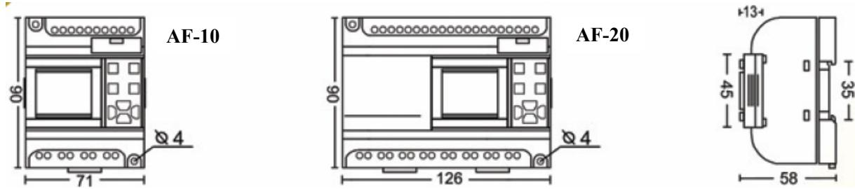
Рис. 2.3 Серия AF-10/20, размеры в мм.
