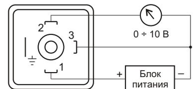
**Пример:** Преобразователь разности давлений PR-50 / диапазон 0 ÷ 2,5 кПа / выходной сигнал 0 ÷ 10 В
