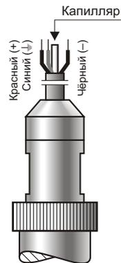
**Зонд PC-28P, электрическое присоединение типа PK**
