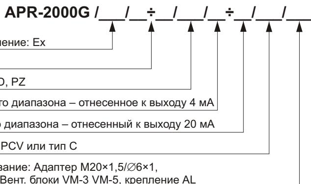
**Пример 1:** Датчик APR-2000G / основной диапазон -700...700 Па / распределительная коробка с зажимами / установочный диапазон -50...100 Па / присоединение типа PCV. Дополнительно адаптер M20x1,5/Ø6x1 – две штуки.
