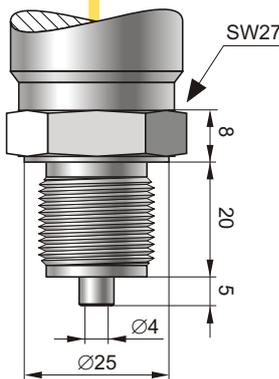
**Тип М** – штуцер манометрический M20x1,5 с отверстием Ø4
